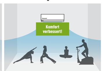
Die Kühlleistung wird durch Absenken der Solltemperatur um 1 Grad erhöht.
