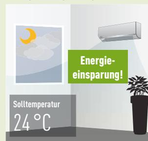
Die Kühlleistung wird durch Anheben der Solltemperatur um 1 Grad reduziert.
